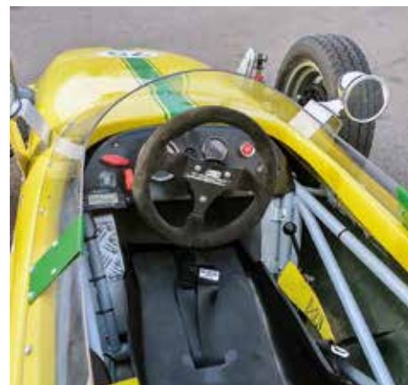
Racers view; här syns tydligt delar av ramkonstruktionen med rundrör. Dolling var en av de absolut första att använda rundrör i ramen i allemansklassen Formula Vee. I mer avancerade racerbilar var det legio sedan länge.
