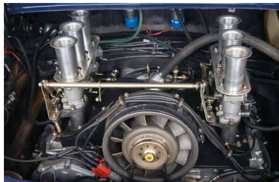
I standardskick ger motorn 130 hästar, Lars motor har 197 och den är byggd av Manfred Rugen i Tyskland. Den har bland annat Solex 40 förgasare och Mahle-kolvar.
