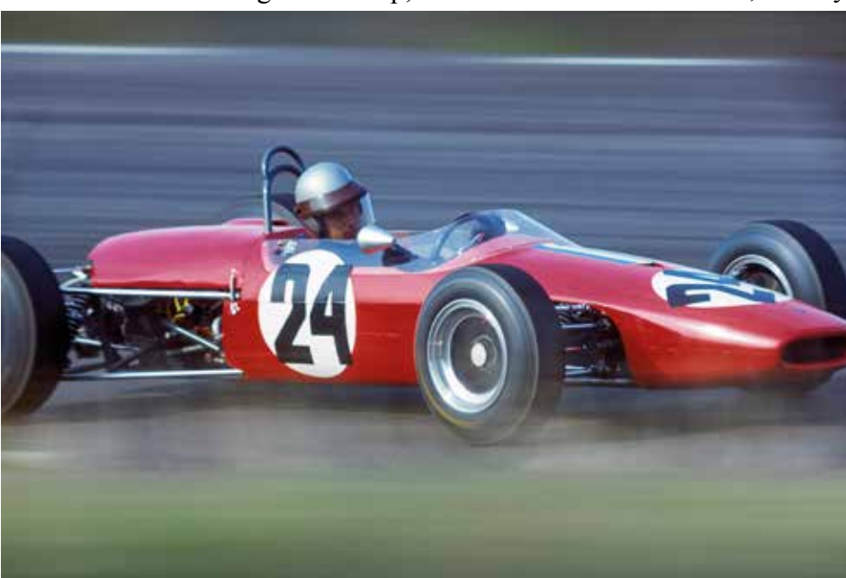
Samtidigt som Jack Brabham koncentrerade sig på racingverksamheten så var det i huvudsak Ron Tauranac som konstruerade Brabham BT21. Den introducerades 1966 och blev genast populär. Den hade rörramschassi och glasfiberkaross. Motorn var på 1000cc och baserades på Ford Anglia. Bilen vägde 409 kg. BT21 skulle byggas i ca 50 exemplar. Totalt med övriga varianter, såsom Formel B och C i USA, kom BT21 att tillverkas i nästan 100 exemplar. På bilden ser vi Uffe på Dalsland Ring Cup 1967, där han slutade fyra.
