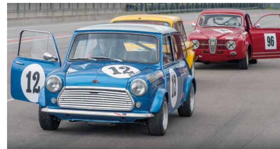
Den senaste bilen är en replika på den Arden Cooper som Gordon Spice körde i engelska mästerskapen 1970. Bilen är tekniskt intressant då den har en crossflowtopp från Arden och fyra Amal-förgasare. En vinnare i Kjells händer.
