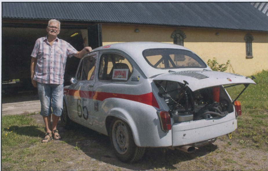
Olof på Fjellbacka gård med den ena av två i Sverige idag rullande Abarth 1000. Vikten är låga 583 kg som vilar på Abarths 5 1/2 tums Campagnolo magnesiumfälgar.
