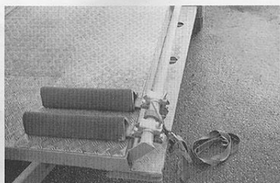
En annan lösning, dock inte fullt lika smidig som den helt mobila, är detta system med klotsar som löper på ett fast rör vilket även agerar förstängning i sidled.
