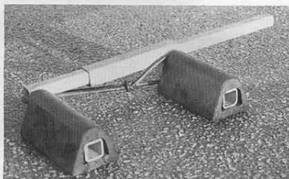
Detta är en mycket anpassningsbar lösning av förstängningskravet, som Bålsta släpet tagit fram till sin nya biltransportkärra av större format. Systemet är enbart godkänt som förstängning tillsammans med surring av hjul.
